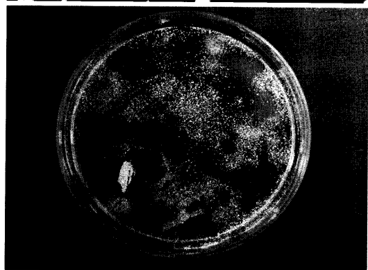
図6 ピストンコアサンプルを椀がけした後の残渣(シャーレに残った残渣のほとんどが有孔虫である)とその実体顕微鏡写真。ルーペを使用するとこの程度の見え方をする。
