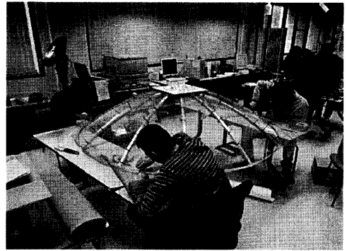
図1 学生が製作中のパラボラ鏡。組み立てた骨組みに金網を張っているところ(和歌山大学学生自主創造科学センターにて)。
