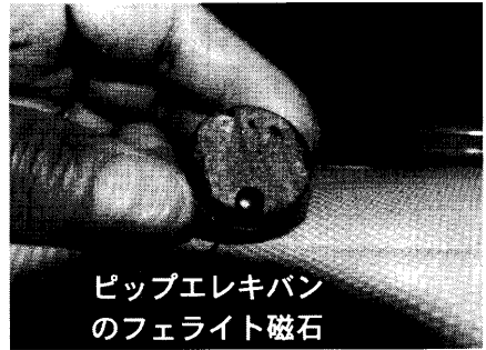
図2 溶岩試料と市販の磁石がくっついている様子 (1) ネオジウム磁石, (2) 磁気健康器具のフェライト磁石.
