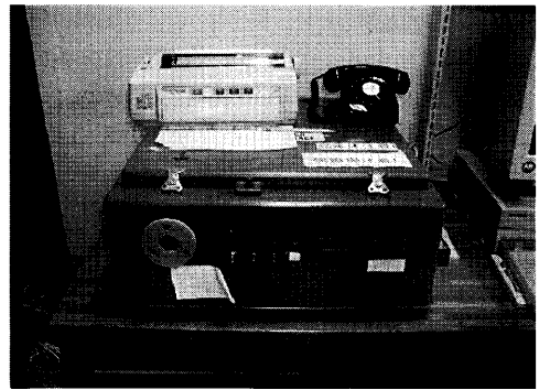
図 1 産業技術総合研究所のパルス磁化器 最大 2.5 T (テスラ) までの磁場をかけることができる。
