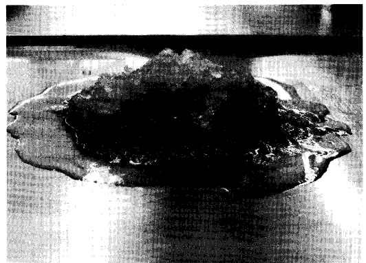
図3 55~50°Cの固化油で、高粘性の流紋岩質溶岩を表す
